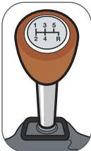
Une transmission manuelle est toujours utilisée avec une pédale d'embrayage. Le levier de vitesses est monté sur le plancher ou sur la colonne de direction. Les transmissions manuelles sont proposées en trois, quatre, cinq ou six vitesses. Consultez votre manuel d'utilisation lorsque vous apprenez à utiliser le levier de vitesses de votre véhicule.
